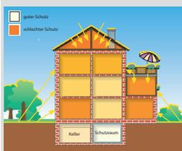
Lage und Bauweise des Raumes sind für die Belastung durch äußere Strahlung von großer Bedeutung.
