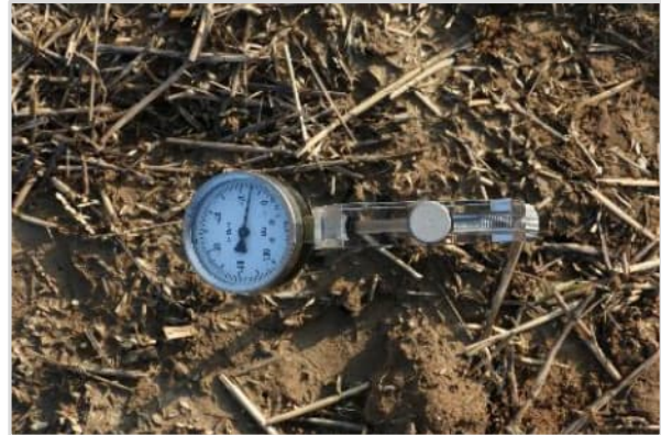
Abbildung 23: Messung der Bodenwasserspannung mittels Tensiometer (© Schnittstelle Boden)
