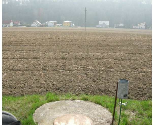
Abb. 3-7: Lysimeteranlage sgPU - Deckel des Messschachts
