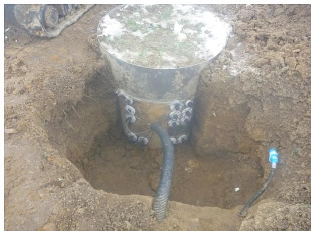
Abb. 6-2: Bestückung des Lysimeters mit Saugspannungs- und Wassergehaltssensoren
