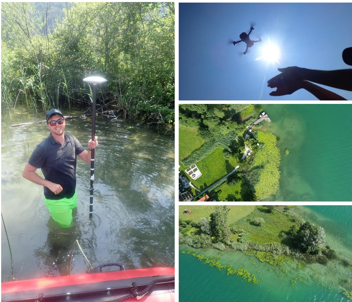
Abb. 13: Einmessung von Ufer- und Passpunkten sowie Bilder der Drohnenbefliegung.
